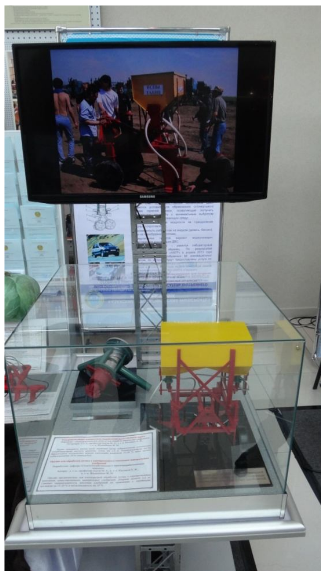
Макет инновационного орудия для основной обработки почвы с одновременным внесением минеральных удобрений
