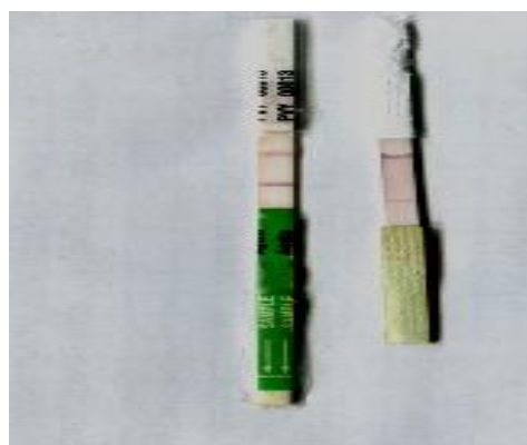
Рис. 13 - Экспресс-диагностика УВК в листовых образцах картофеля тест-полосками
