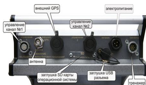
Рис. 59 – Блок контроля и управления ДСМ, вид снизу
