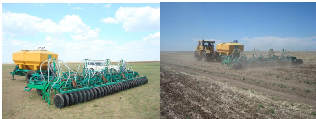
Рис. 63 - Экспериментальный образец сеялки для посева с одновременным внесением минеральных удобрений Рис. 64 - Полевые работы
