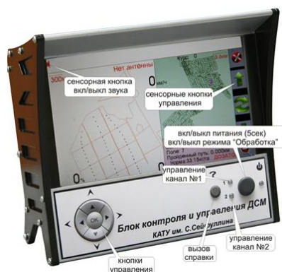
Рис. 58 - Блок контроля и управления ДСМ, вид спереди
