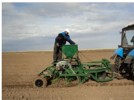
Рис. 60 - Производственная проверка автоматизированной машины для дифференцированного применения семян и удобрений
