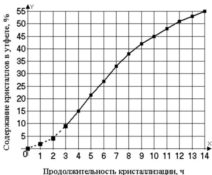
Рисунок 1. Образование и наращивание кристаллической массы при комбинированном способе кристаллизации: - - - в выпарном аппарате; - - - - в кристаллизаторе
