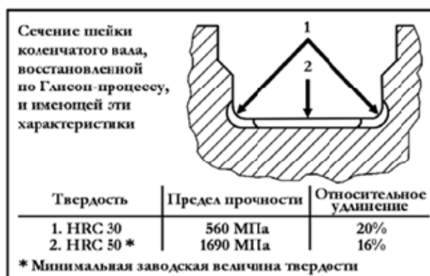
Рис. 2. Физико-механические свойства металла восстановленного коленчатого вала после наплавки двумя проволоками
