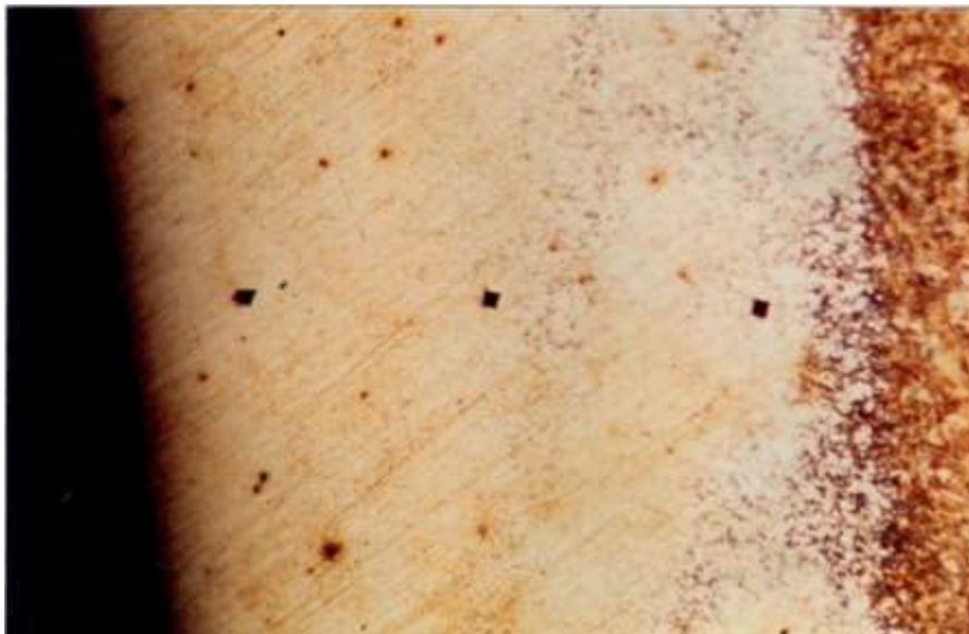
Рисунок Г.3 – Структура зоны микроплавления поверхности, 1589 HV, x100
