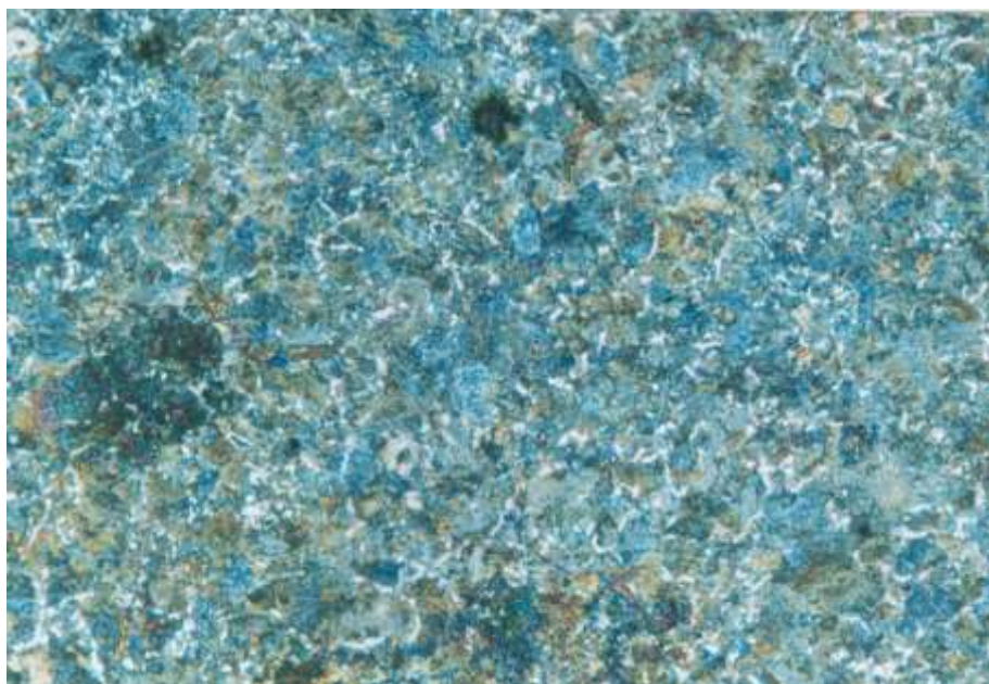
Рисунок Г.1 – Зона исходной структуры и твердости, 404 HV, x200
