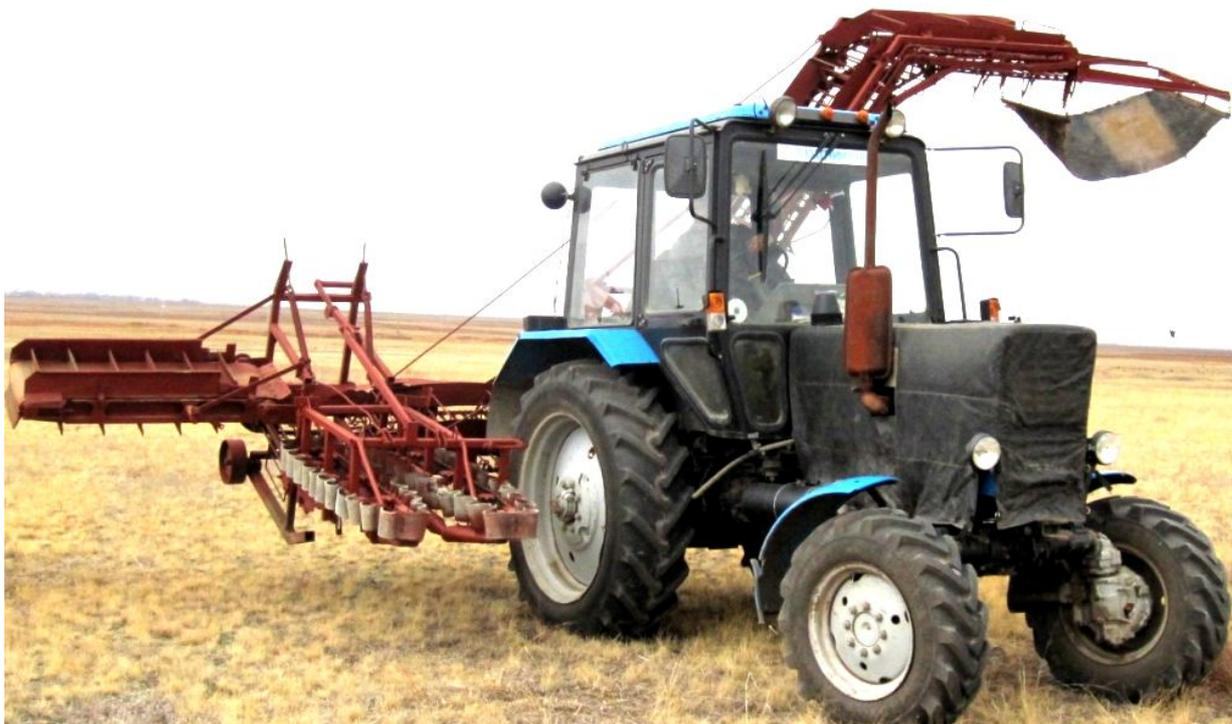
Универсальная навесная машина НКМ-1 предназначена для выборочной и сплошной уборки ранних, среднеспелых и поздних сортов кочанной капусты, выращиваемой на всех видах почв, как на ровной, так и на гребневой поверхностях. Агрегируется капустоуборочная машина с тракторами класса 14 кН (МТЗ-82) или 20 кН (Т-70С) и обеспечивает одновременно погрузку кочанов в рядом идущее транспортное средство.
