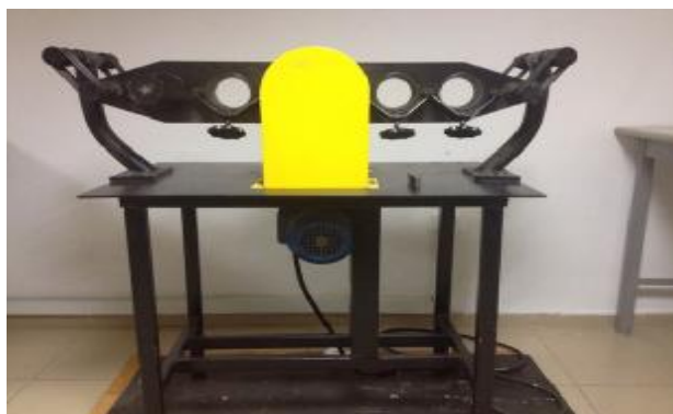
Сурет-2 – 75 Т-ДРМ Вибрационды үгіткіш
