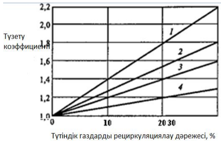
Газды беру: 1 – үрлемелі ауаға; 2 – жанарғы астындағы шүмекке; 3 – жанарғыға қарсы шүмекке; 4 – оттық астына 1 – сурет. Жану өніміндегі БП түзілуіне газмазутты қазанның оттығына газ рециркуляциясын берудің түрлі әдістерінің әсері
