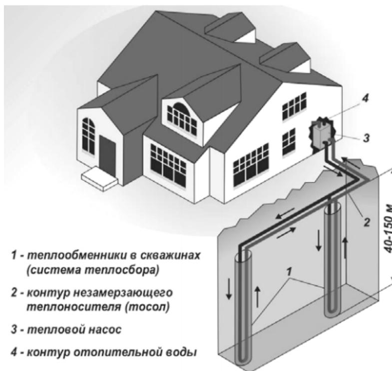
Рисунок 1. Принципиальная схема системы автономного теплоснабжения на основе теплонасосной станции с закрытым контуром и вертикальными грунтовыми теплообменниками.
