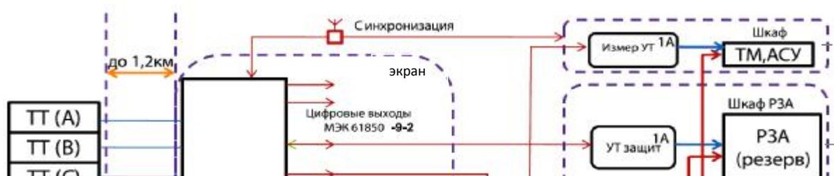
Рисунок 2 - Схема воздействия помех на оборудование подстанции с обычными измерительными трансформаторами
