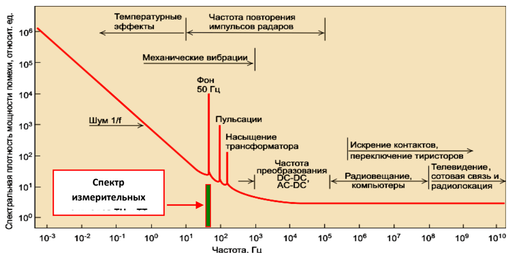
Рисунок 1 - Характеристики и частотные спектры источников электромагнитных помех и полезных измерительных сигналов
