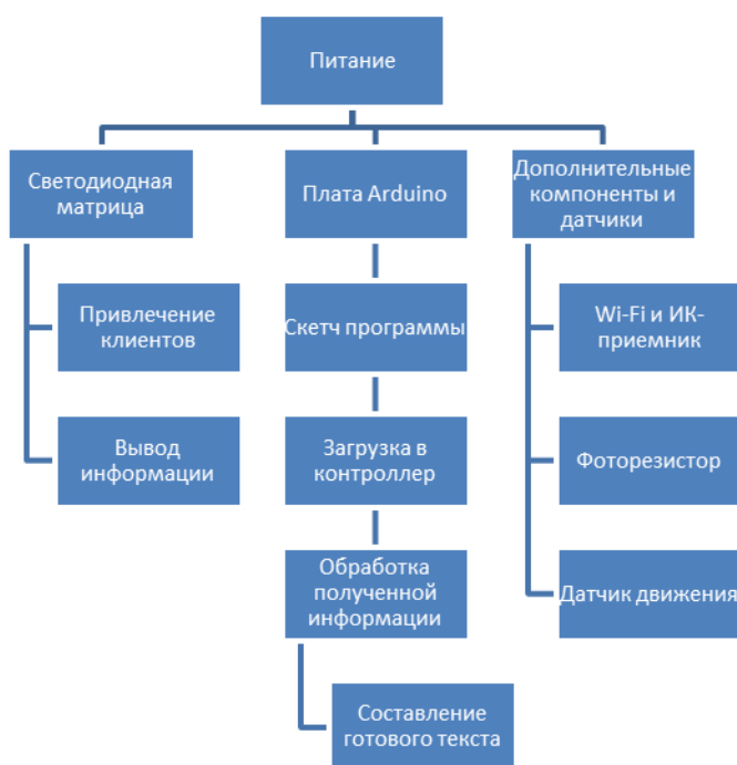
Рисунок 1. - Структурная схема основных компонентов устройства
