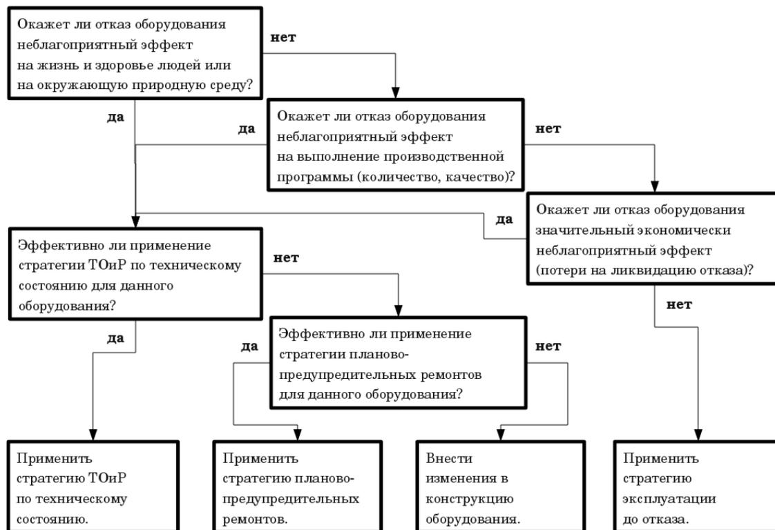
Рисунок 1 – Упрощённая типовая схема принятия решений
