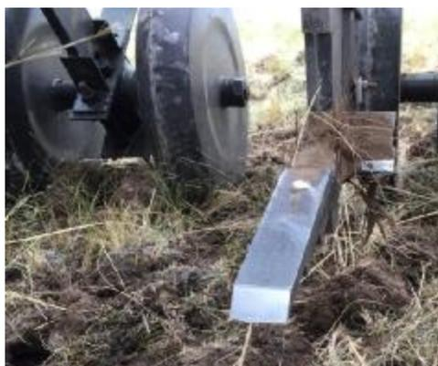
Рисунок 2 - Форма износа долота (изделие-аналог без упрочнения)
