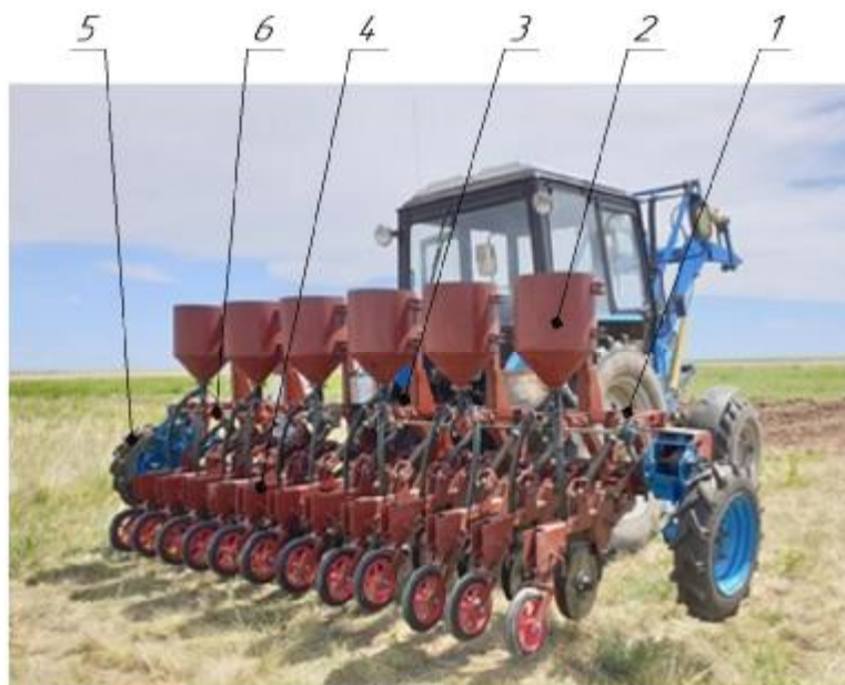
Рисунок 1 — Макетный образец сеялки для посева нессыпучих семян трав: 1 — рама; 2 — семенной ящик с высевальными аппаратами; 3 — навесное устройство; 4 — посевная секция; 5 — ходовая часть; 6 — привод высевальных аппаратов.
