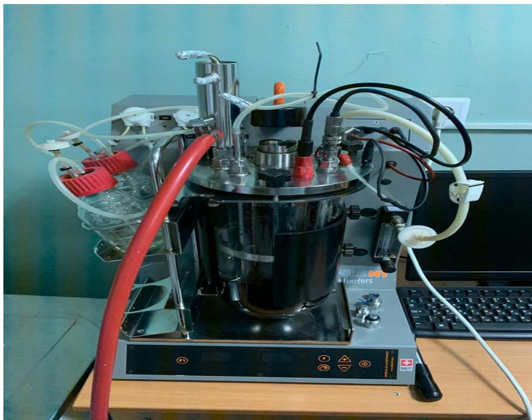
Рисунок 1 – Лабораторный ферментер «*Minifors*» (Швейцария), готовый к глубинному культивированию лактобактерий
