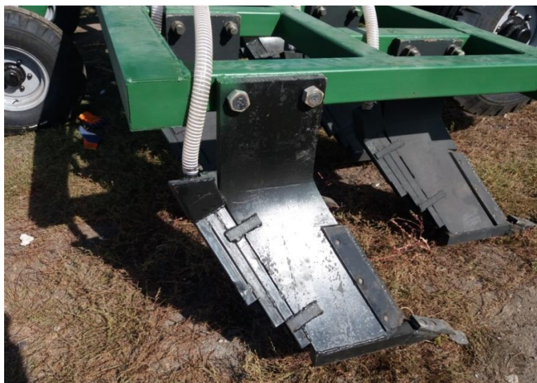
Рисунок 2 – Рабочий орган с распределителем
