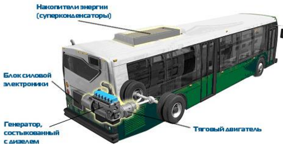
Рис. 1. Функциональная схема комплекта тягового электрооборудования, выполненного по последовательной схеме
