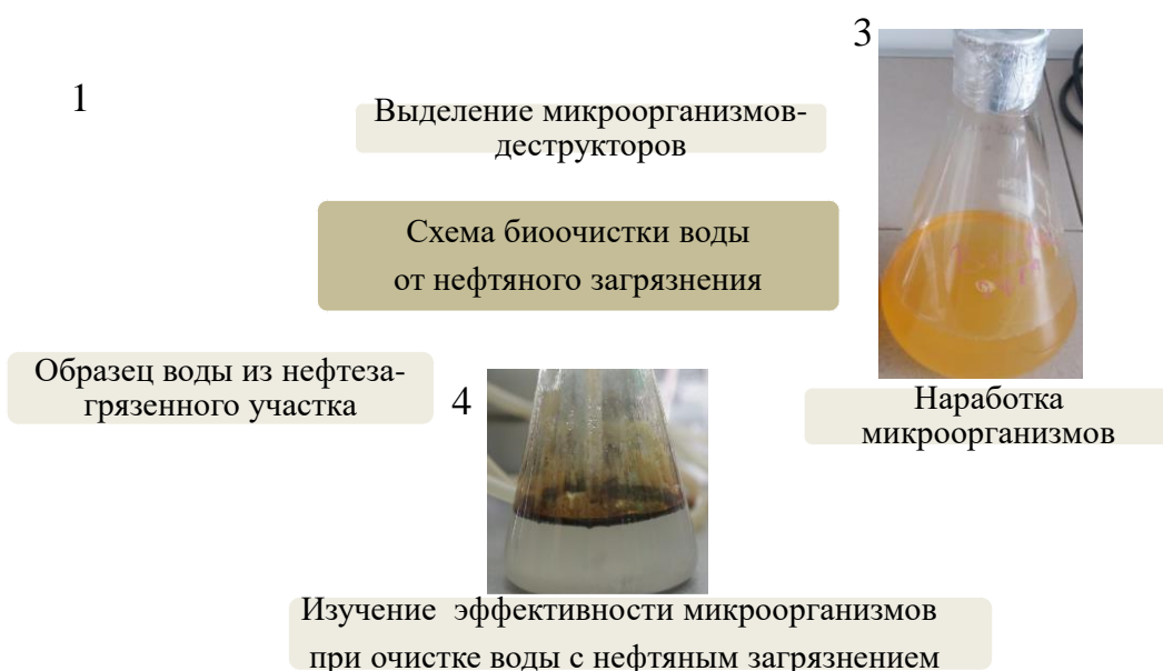
Рисунок 1 – Схема биоочистки воды от нефтяного загрязнения с использованием выделенных микроорганизмов
