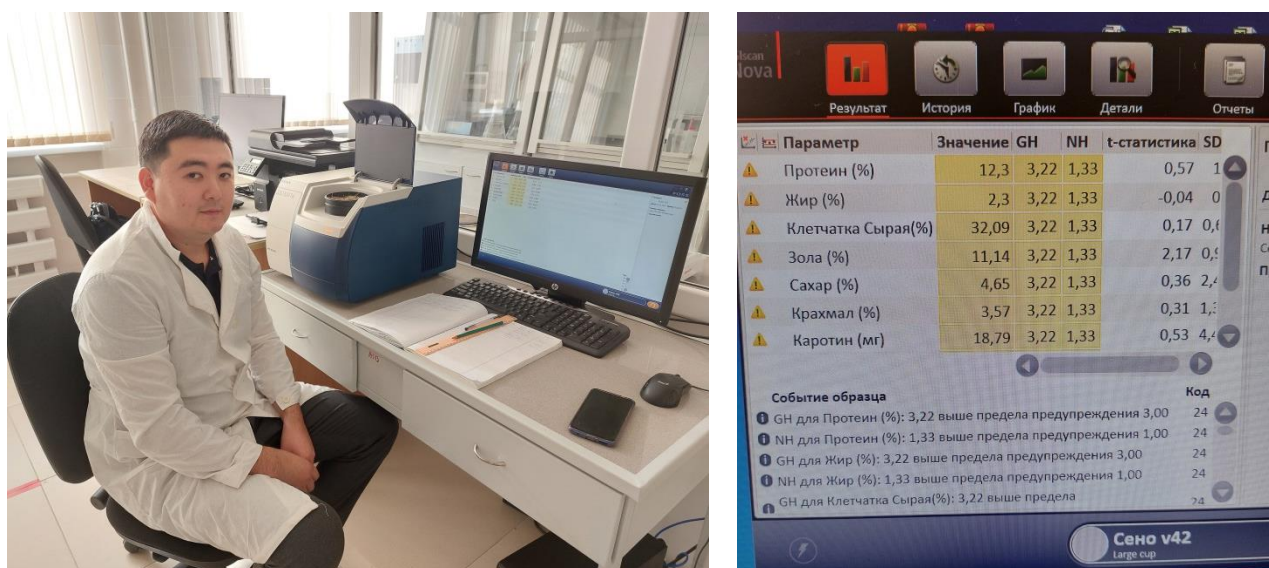
Рисунок 12 – Определение химсостава кормов на приборе FOSS NIRS DS2500, НАО «КАТИУ им. С. Сейфуллина»
