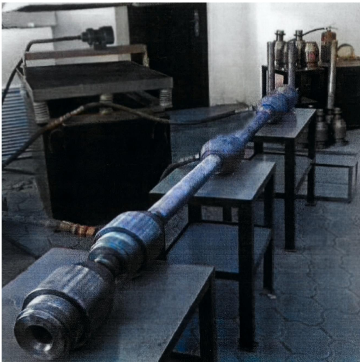
Рисунок 29 – Установка ускоренного охлаждения
