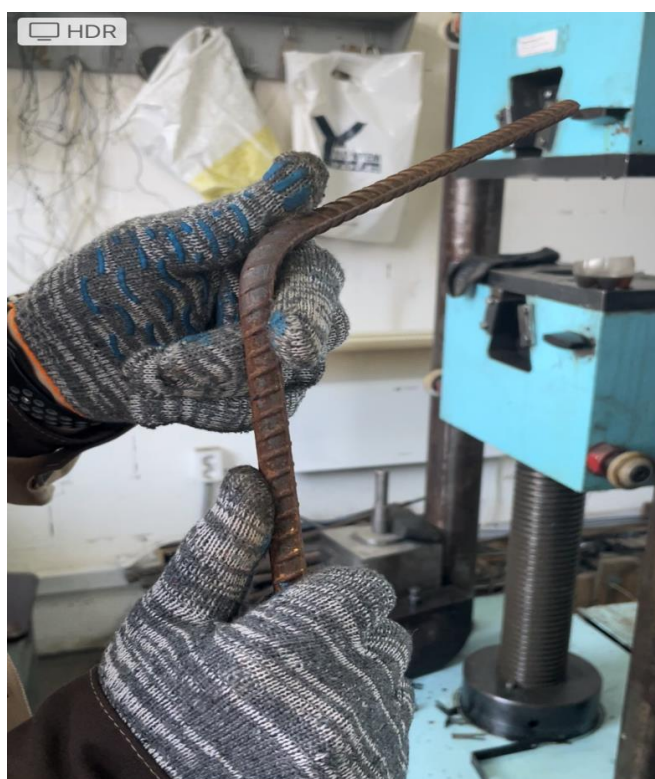
Рисунок 20 – Арматурный стержень после «изгиба»
