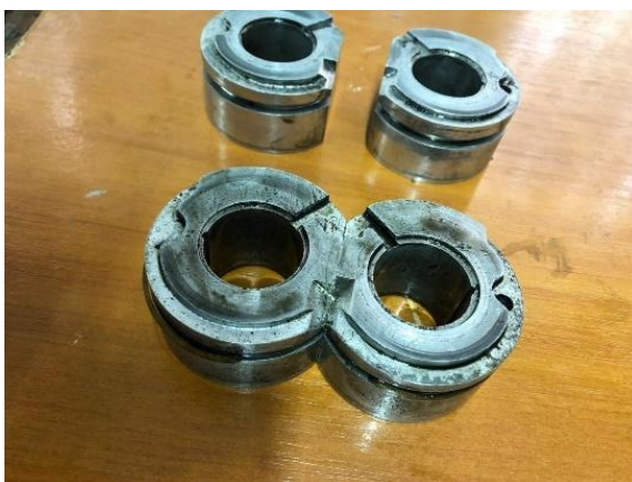
2.3-сурет – Өңделмеген тірек төлкелер.
