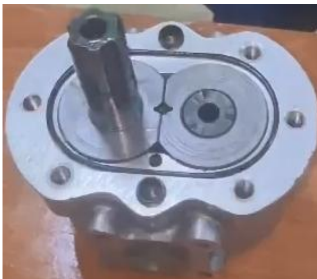
3.2-сурет - V-тәрізді ойықтары бар тірек төлкелерімен жинақталған ЕОҚ бар ТС.
