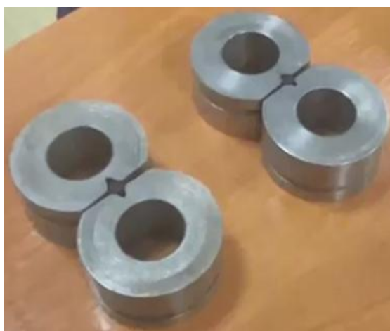
2.4-сурет – V-тәрізді ойықтары бар тірек төлкелері.
