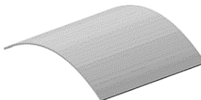
4.17-сурет – «ПС ЛИРА» бағдарламасында әзірленген серпімді жылжымалы элемент профилінің моделі
