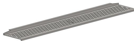
Рисунок 2.9 – Верхняя платформа с отверстиями (масса 52 кг)
