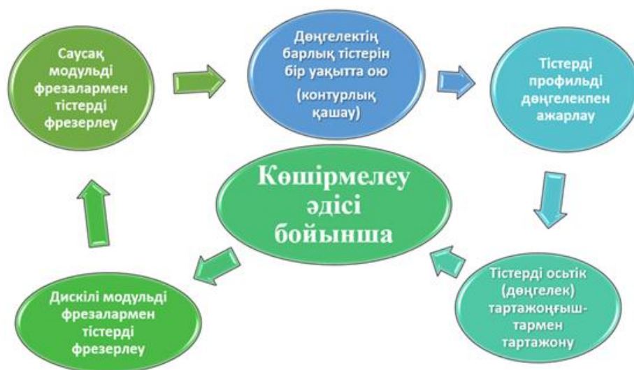
1.6 - сурет - Тісті дөңгелектерды көшірмелеу әдісі бойынша өңдеу түрлері
