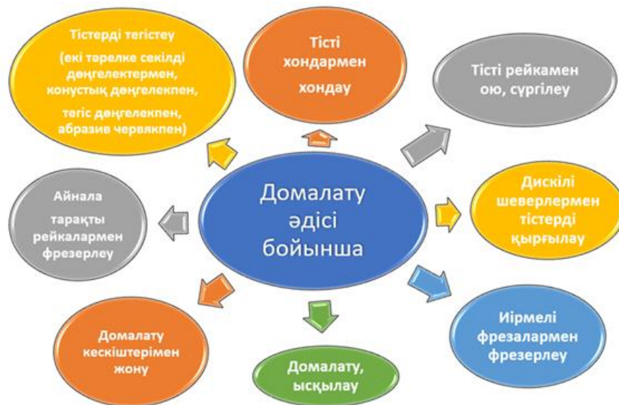
1.7 - сурет - Тісті дөңгелектерді домалату әдісі бойынша өңдеу түрлері
