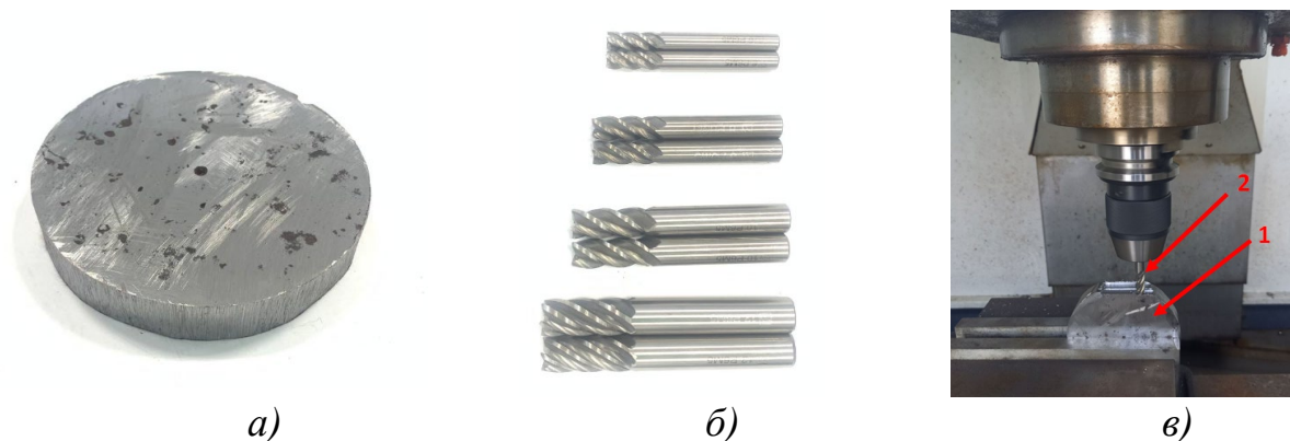
а - болат 45 дайындама; б - саусақты фрезалар (диаметрлері 6, 8, 10, 12 мм); в - ысқылап қалыптастыру үрдісі; 1-дайындама; 2- саусақты фреза.
