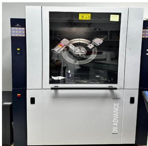
Рисунок 11 – Рентгеновский дифрактометр D8 ADVANCE (Bruker)
