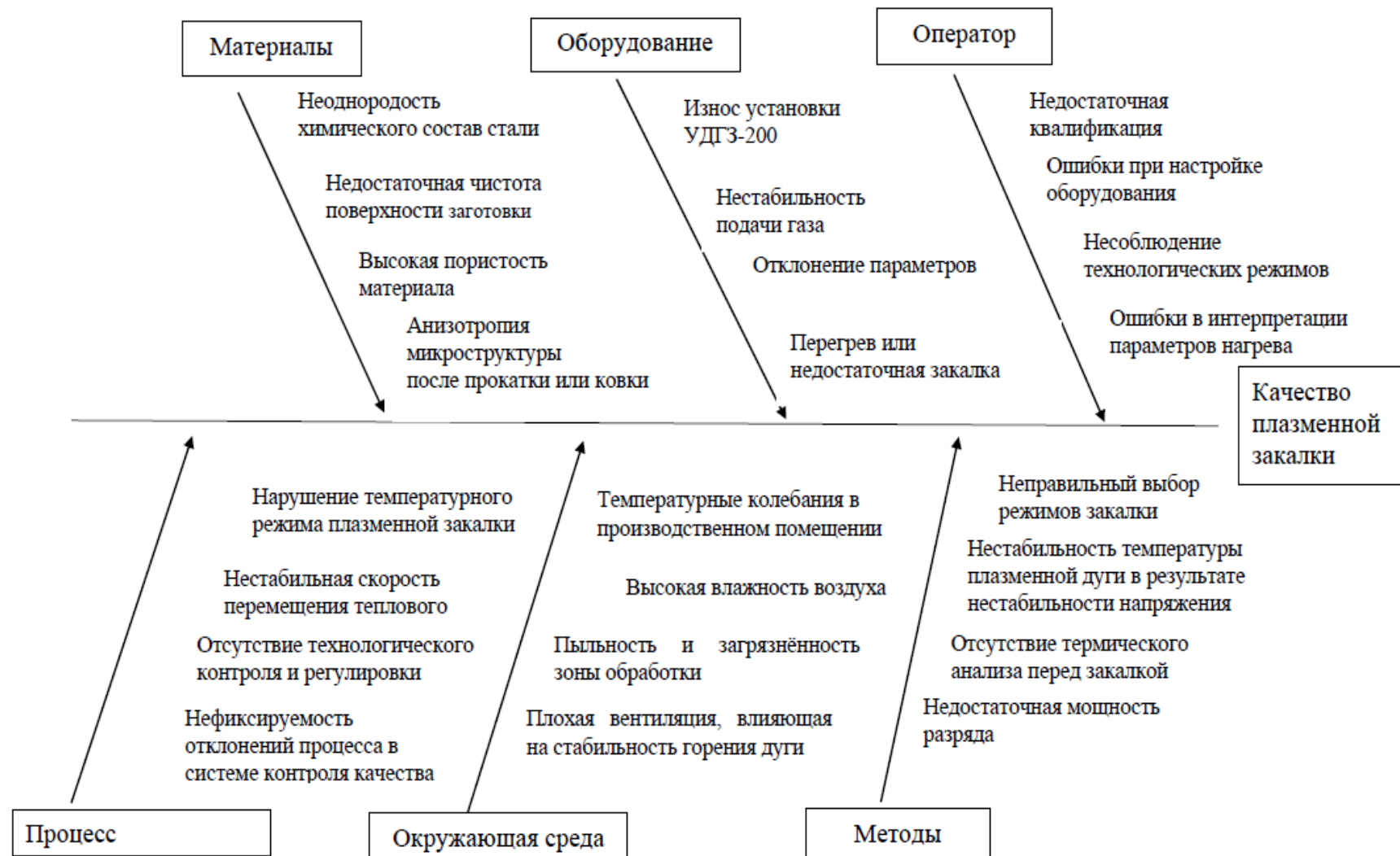
Рисунок 4 – Диаграмма Исикавы для процесса плазменной закалки
