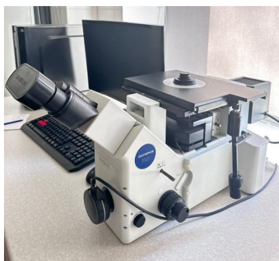
Рисунок 16 – Оптический микроскоп OLYMPUS GX51
