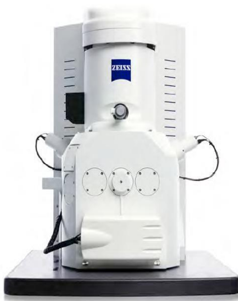
Рисунок 10 – Сканирующий электронный микроскоп ZEISS EVO-18
