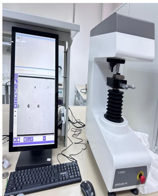
Рисунок 12 – Микротвердомер Metkon Duroline-M
