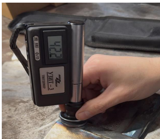
Рисунок 14 – Ультразвуковой твердомер УЗИТ-3
