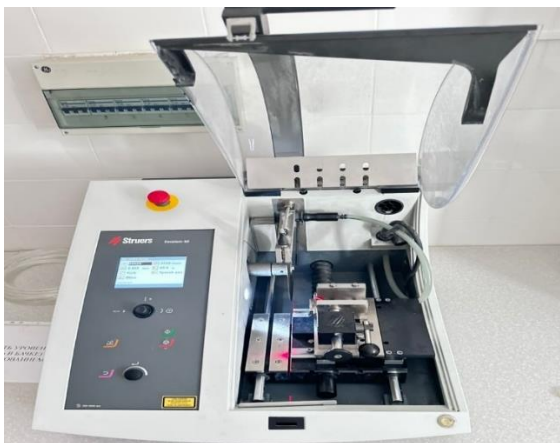
Рисунок 6 – Отрезной станок Secotom-60 (Struers)
