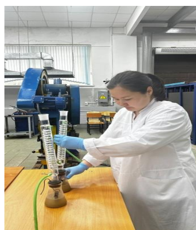
Рисунок 19 – Испытательный стенд для определения коррозионной стойкости материалов в агрессивной среде
