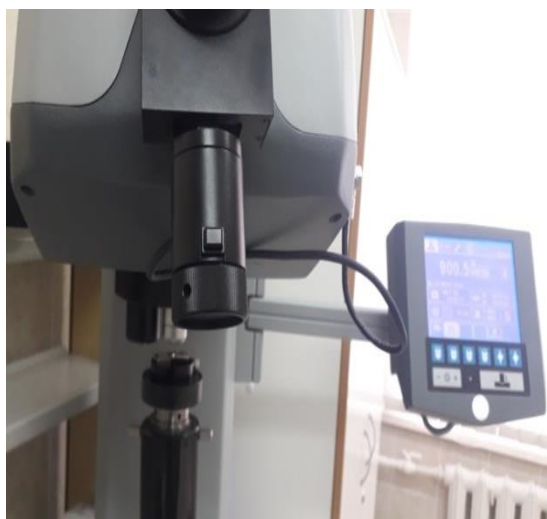
Рисунок 13 – Твердомер макро Виккерса Wilson VH 1150
