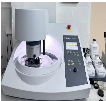
Рисунок 7 – Шлифовально-полировальный станок Tegramin-25 (Struers)
