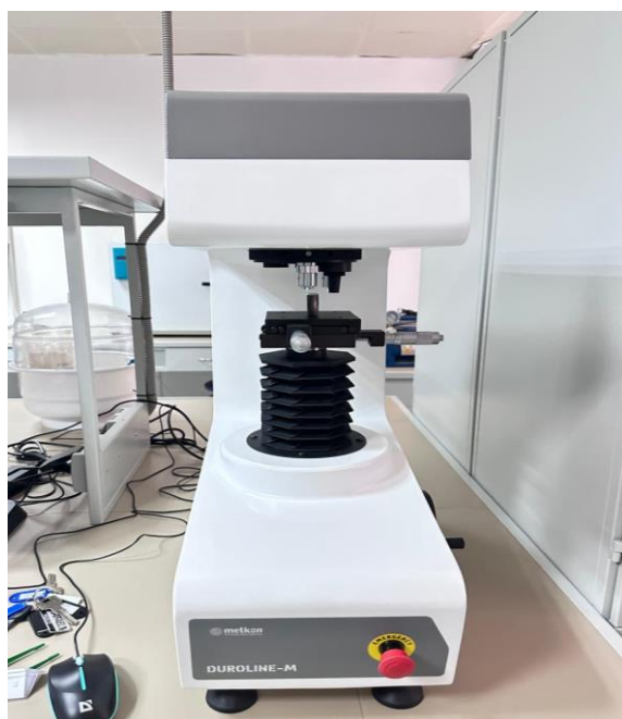
Рисунок 12 – Микротвердомер Metkon Duroline-M
