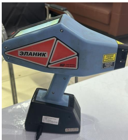
Рисунок 9 – Лазерно-искровой спектрометр Эланик
