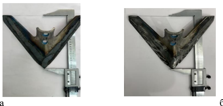
Рисунок 37 – Внешний вид обработанных лемехов плуга до и после полевых испытаний
