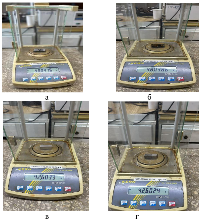
Рисунок 45 – Взвешивание массы образцов
