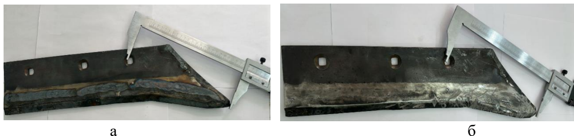
Рисунок 36 – Внешний вид обработанных лемехов плуга до и после полевых испытаний
