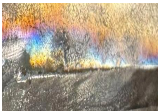
Рисунок 27 – Макроплавление стали 65Г
