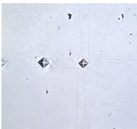
Рисунок 31 – Расположение отпечатков микротвёрдости
