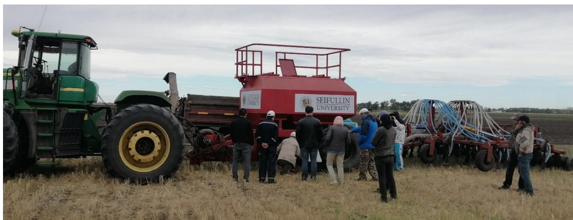
Сурет 3.4 – Тұқым мен минералды әртүрлі тереңдікке енгізетін сіңіргіш анкері орнатылған кең алымды сепкіш
