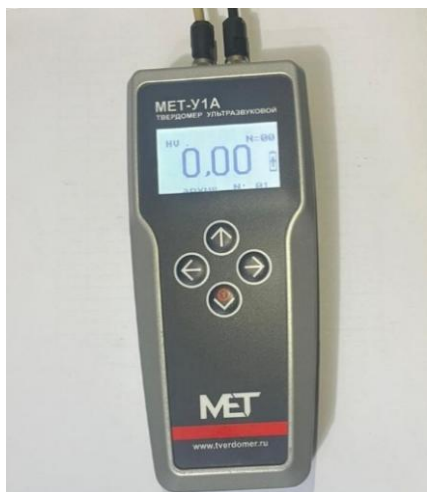
а – MET-U1A ультрадыбыстық қаттылық өлшегіш
