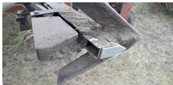
Сурет 4.11- Экспериметтік сынақтардан кейінгі анкер үлгілерінің күйі
