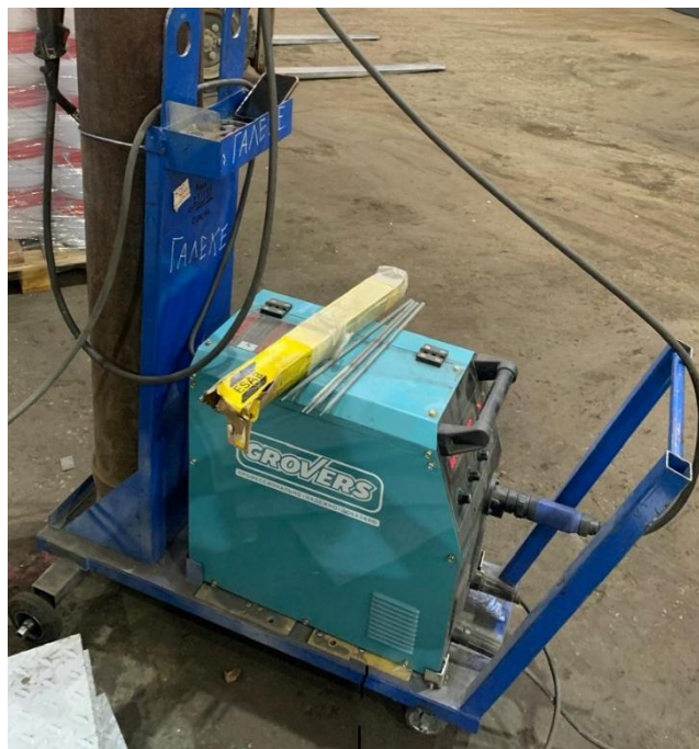
Сурет 3.1 - Grovers MMA-200G Professional инверторлық дәнекерлеу аппараты
