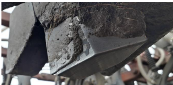
Сурет 4.11- Экспериметтік сынақтардан кейінгі анкер үлгілерінің күйі
