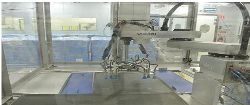
Рисунок 2 – Роботизированная рука Omron для производства макаронных изделий
