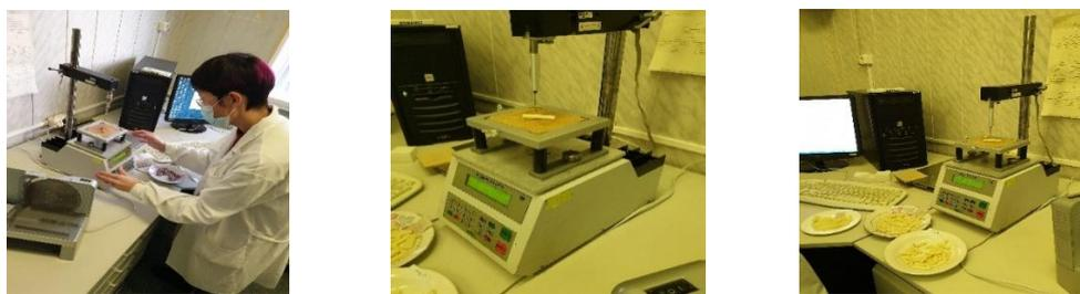
Рисунок 12 – Структурометр СТ-1М
