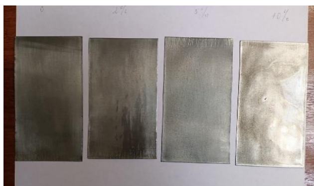
Рисунок 15 – Образцы на основе эпоксидной смолы для проведения испытаний с различным массовым содержанием наполнителей
