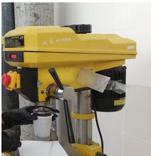
Рисунок 16 – Процесс перемешивания эпоксидной смолы с наполнителем
