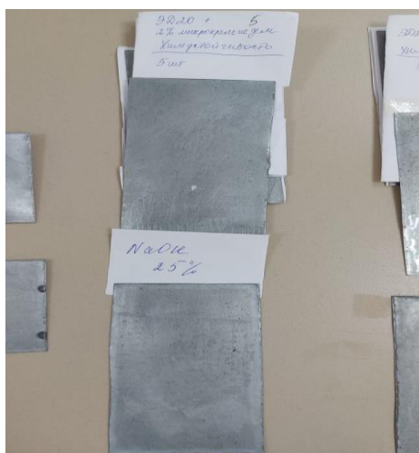
Рисунок 32 – Образцы покрытия на основе эпоксидной смолы с добавками 2 % микрокремнезема после выдержки в 25% растворе NaOH в течение 24 часов в сравнении с контрольным образцом.
