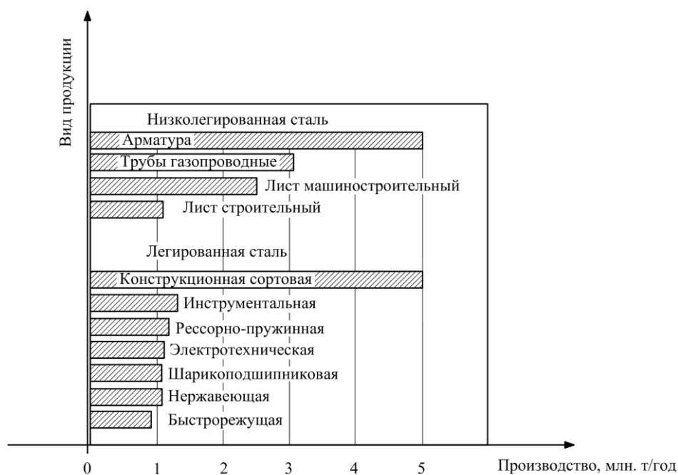
Рисунок 6 – Структура производства готового проката по назначению
