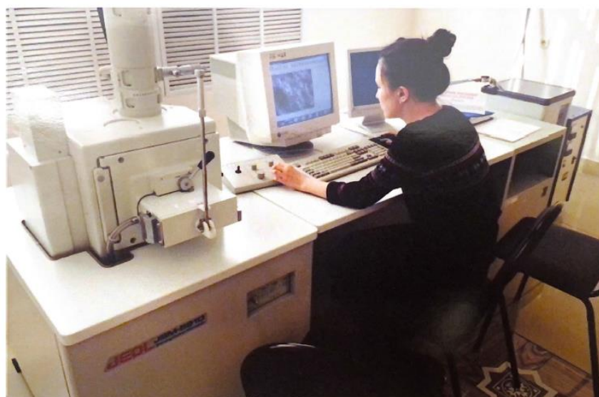
Рисунок 12 – Процесс работы с электронным сканирующим микроскопом JEOL 5910
