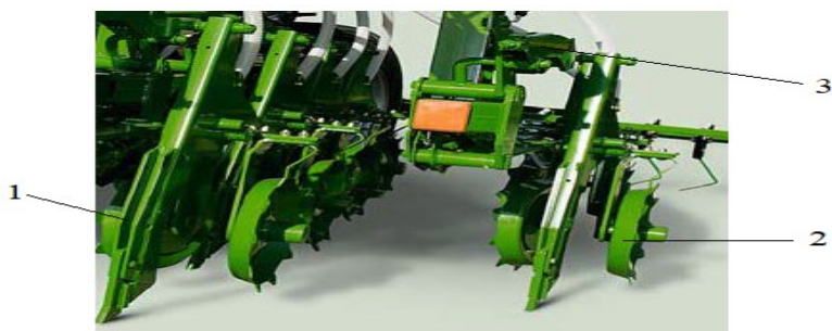
2 - сурет – Amazone primera DMC сепкіштің ашқышы: 1-қашау тәрізді ашқыш; 2-каток; 3-параллелограмм механизмі
