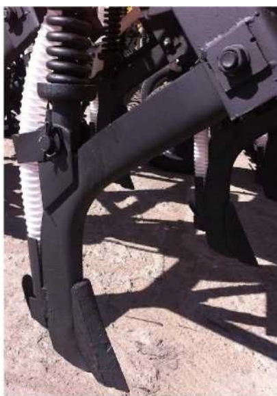
3-сурет – Анкерлік А40 сошник СКП-2.1 сеялқалары
