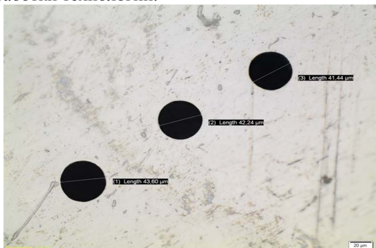
Рис.2. Микроотверстия в тонкой пластине из нержавеющей стали Разрешающая способность при копировании регулярного рельефа с торца электрод-инструмента на деталь находится в субмикронном диапазоне и достигает величин 0,5...3
