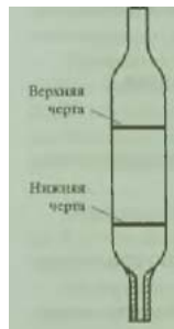
Рисунок 4. Пипетка для определения степени гомогенизации молока
