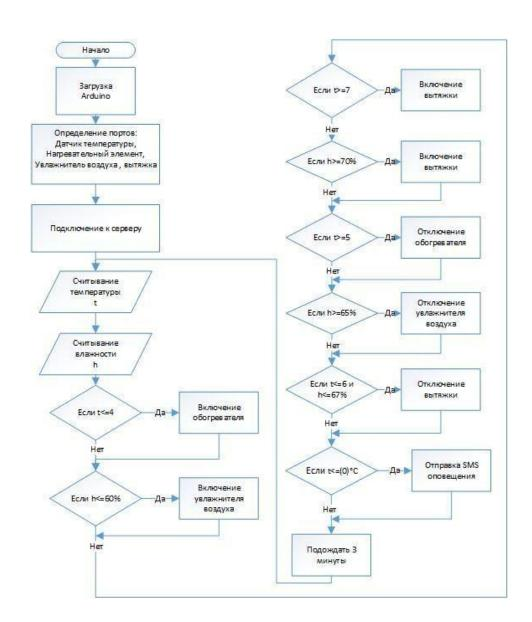
Рисунок 1 — **Блок-схема алгоритма работы системы управления микроклиматом**
