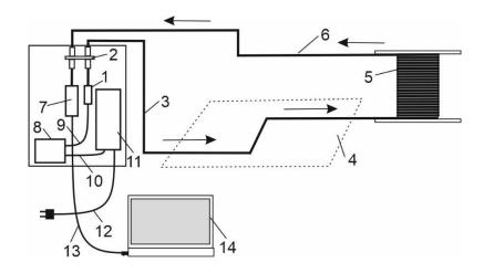
Источник лазерного излучения — 1; оптически кросс — 2; ВОК — 3 (прямое направление); основание — 4; катушку — 5; ВОК — 6 (обратное направление); блок предварительной обработки данных — 7; источник питания — 8; электрический проводник — 9, 10; ИБП — 11; сетевой шнур 12; кабель USB —13; компьютер —14.
