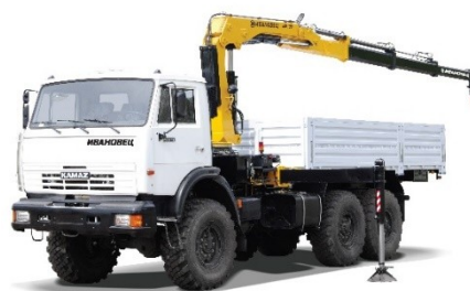
Рисунок 3 – Грузовой автомобиль КамАЗ-43118 с крано-манипуляторной установкой.
