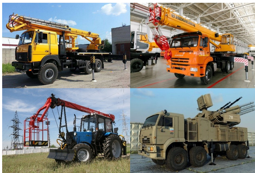
Рисунок 2 – Применение выносных опор в различной специализированной технике.
