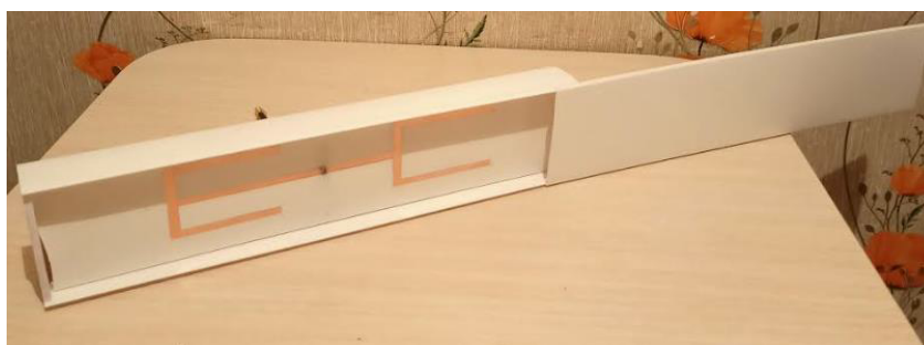
Рис. 4. Прототип микрополосковой антенны с частотой 868 МГц
