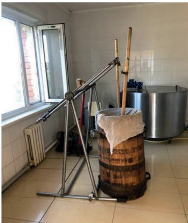
Рисунок 1 - Автоматизированная мешалка для сбивания кумыса возможность одновременно мешать от 2-х до 4-х бочек кумыса.
