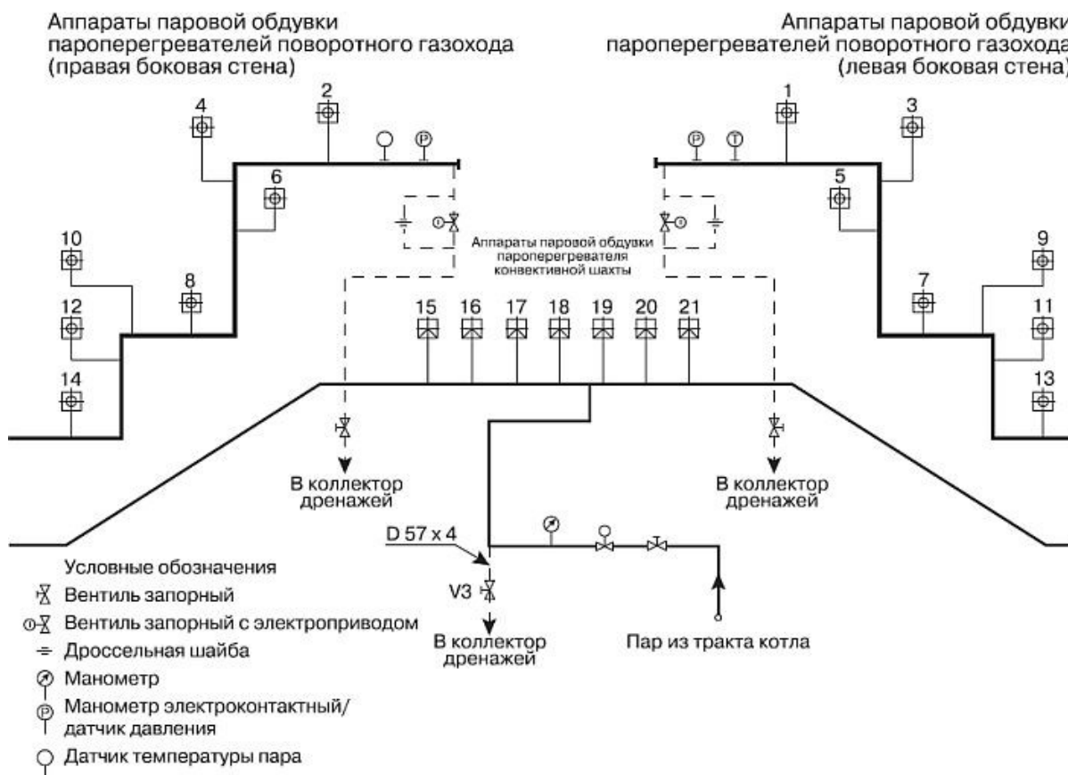
Сурет 1. Қазандықты бумен үрлеудің технологиялық схемасы
