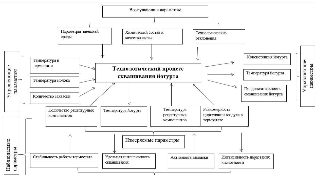
Рис 1. Параметрическая схема технологического процесса сквашивания йогурта
