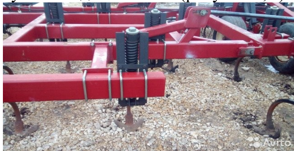
а – Рама пневматической сеялки-культиватора Salford 580
