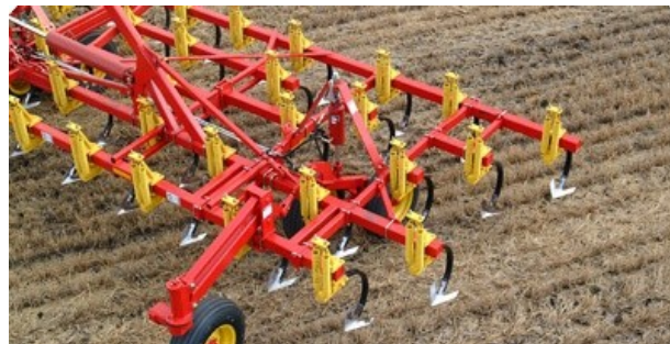
б – Рама посевного комплекса культиваторного типа Bourgault 8910
