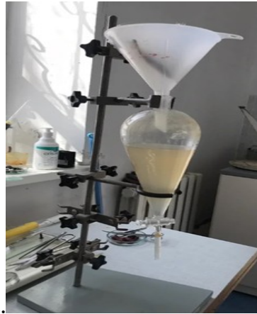
Сурет-3. а. Конус тәрізді Trichinella spp. личинкаларын бөліп алуға арналған қондырғы. в. Магнитті мешалкадағы сынаманы араластыру
