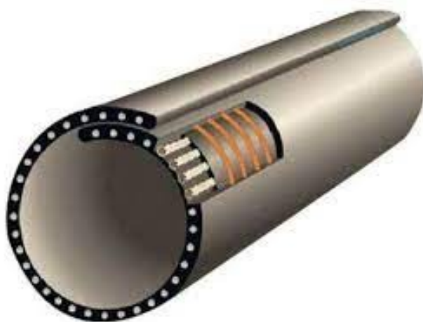
3 сурет - Құбырлы таспалы конвейердің иілу көрінісі
