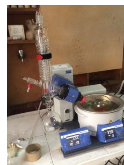
ИКА RV 10 auto айдау құрылғысы және ИКА NB digital су моншасы
