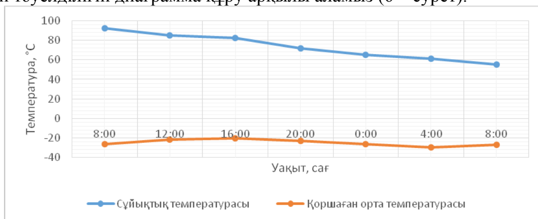
Сурет 6 – Жылу аккумуляторындағы салқындатқыш сұйықтығының температурасы уақыт шамасы бойынша өзгеру диаграммасы.
