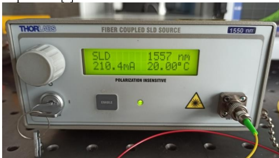
Рисунок 2а. Элементы системы для измерения спектральных характеристик косых решеток Брэгга, при источнике света
