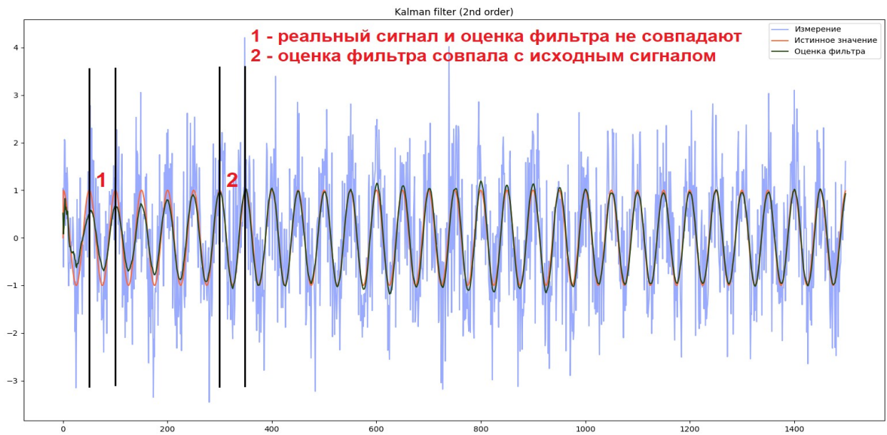
Рисунок 2. Нахождение периода, в котором происходит совпадение оценки фильтра с исходным сигналом
