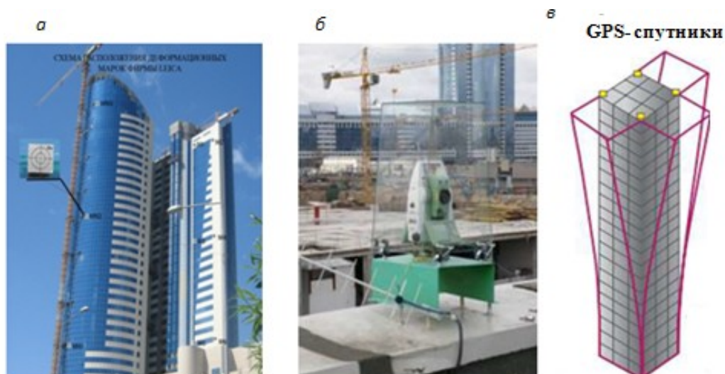
Рисунок 2 - Расположение контрольных марок на объекте (а); мониторинг здания с применением роботизированного электронного тахеометра (б); общая схема GPS-мониторинг ветрового воздействия на высотное здание (в)
