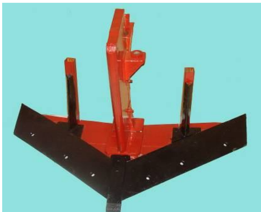
Рисунок 2 – Рабочий орган для внесения минеральных удобрений
