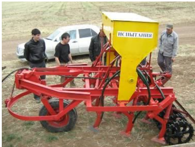
Рисунок 1 – Сеялка для подпочвенного разбросного посева семян зерновых культур с одновременным внесением минеральных удобрений
