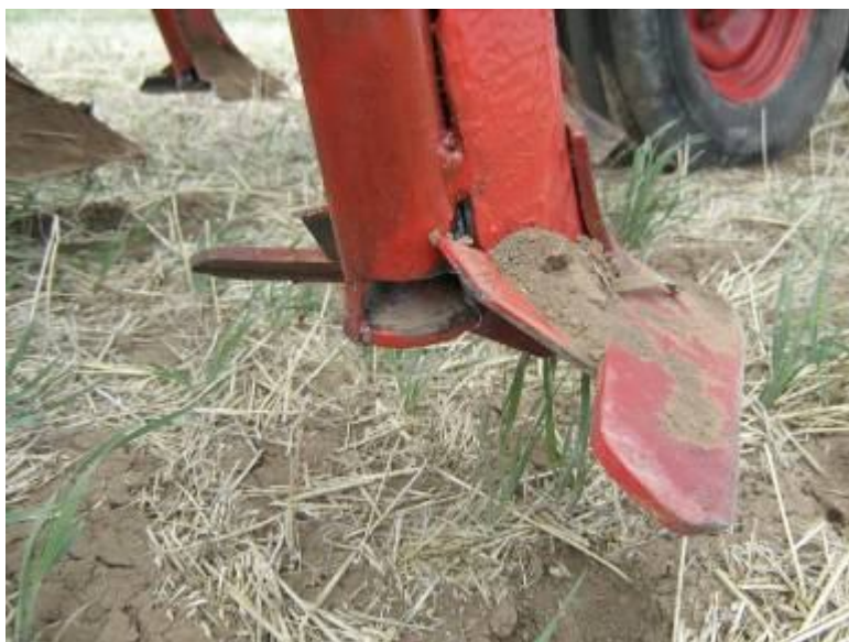
Рисунок 2 – Сошник для разбросного посева семян и внесения минеральных удобрений
