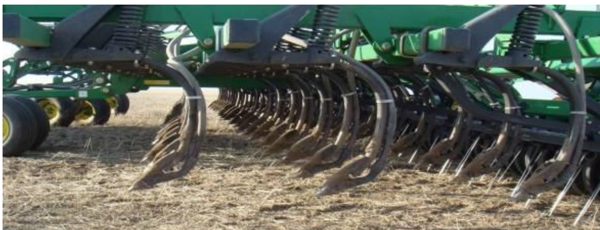
Рисунок 1 - Посевной агрегат с анкерными сошниками
