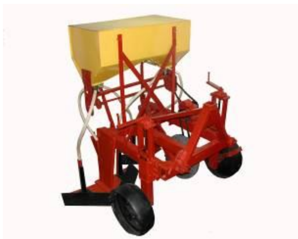
Рисунок 1 – Орудие для внутрипочвенного внесения минеральных удобрений
