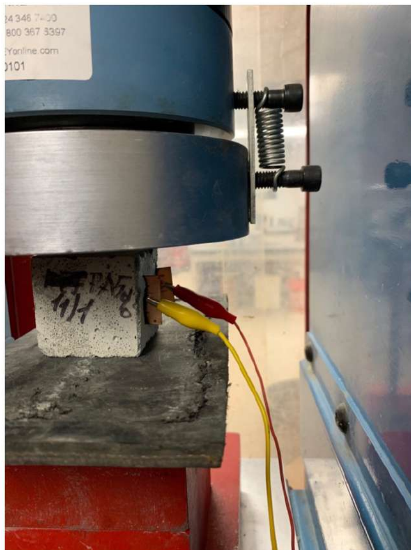
Рисунок А.1 – Установка образца в испытательный пресс и подключение электродов
