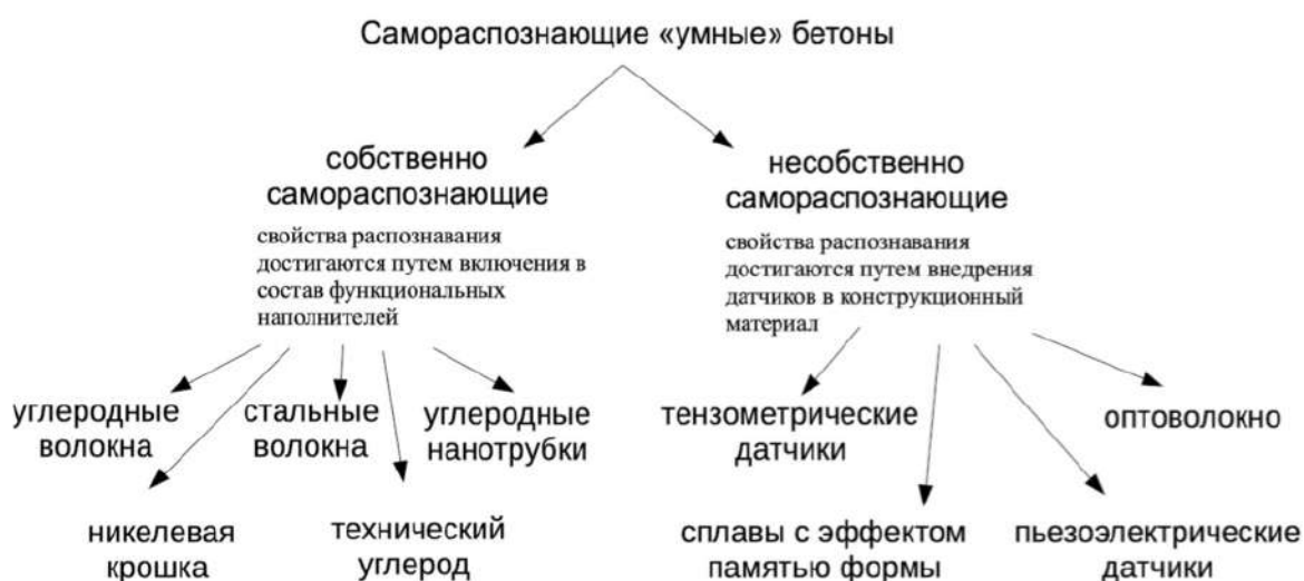
Рисунок 4 – Краткая классификация самораспознающих бетонов
