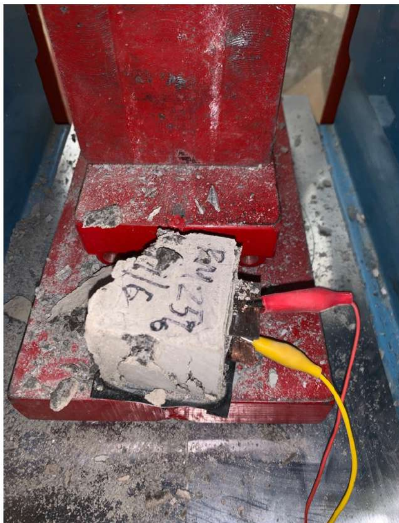
Рисунок А.2 – Образец с электродами после полного разрушения
