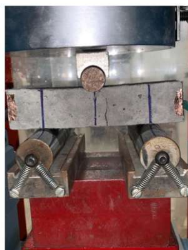
Рисунок А.2 – Образец с электродами после полного разрушения
